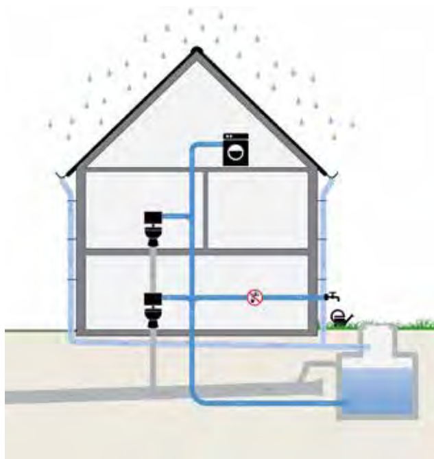
Schematische doorsnede regenwater-gebruikssysteem © Atelier GROENBLAUW
