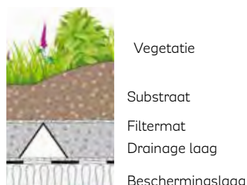
Schematische doorsnede natuurdak ©Optigroen
