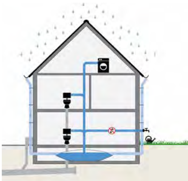
Schematische doorsnede regenwatergebruik-systeem met waterzak © Atelier GROENBLAUW
